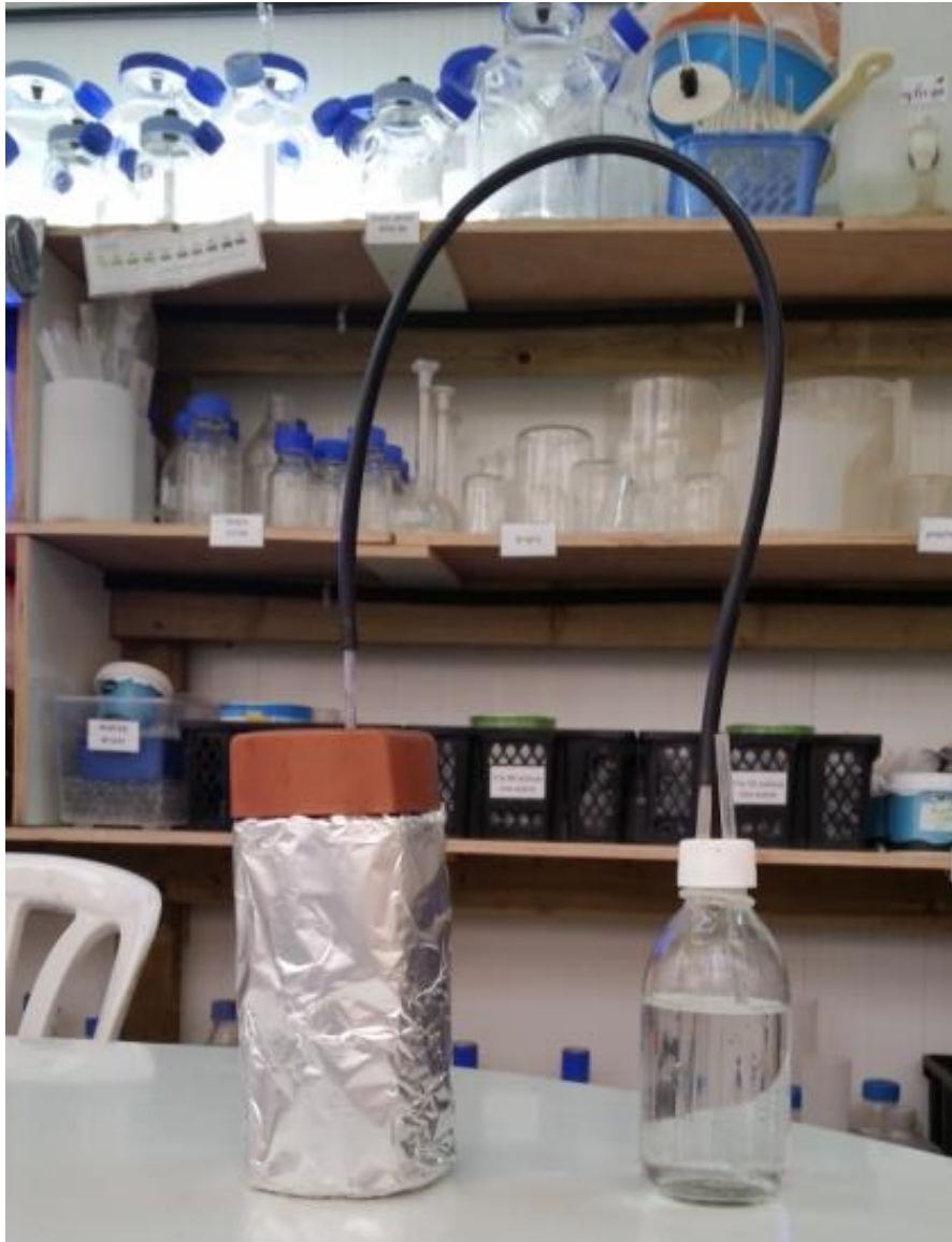
איור 3. המערכת האנארובית הבנוייה על העברת הגזים ממיכל בו מוחזקת הבוצה ע"י צינור פלסטיק לבקבוק מלא במים, אך שהגזים יוצאים דרך המים ונמנעת כניסה לא רצויה של חמצן למיכל הבוצה.
