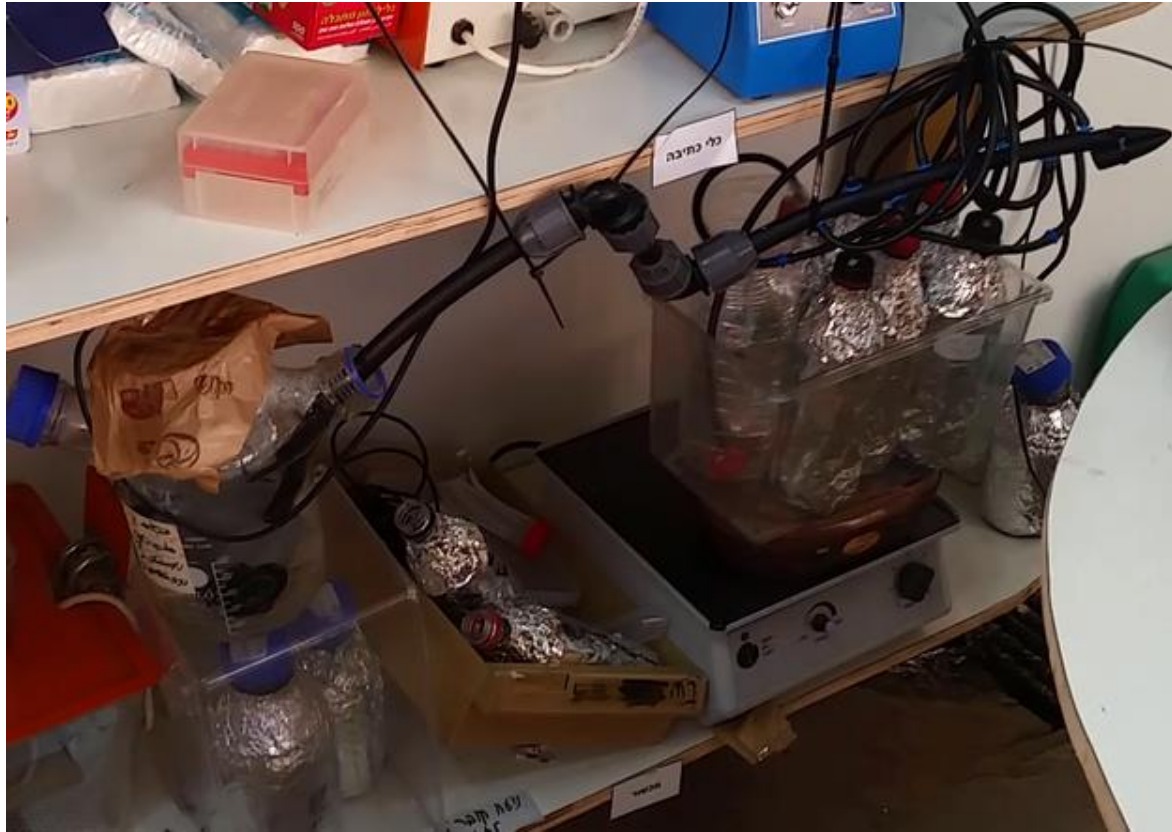
איור 4. מערכת סיפוק תמיסת הסוכר לניסוי. הבקבוקים (העטופים בנייר אלומיניום) נמצאים על המטלטלת ואליהם מחוברת (דרך הפקק) מערכת השקיה (טפטפות) המספקת להם תמיסת סוכר מידי יום ע"י משאבת מים ושעון שבת.
