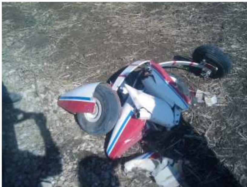
כני הנחיתה הראשיים שנתלשו ממקום חיבורם למטוס
