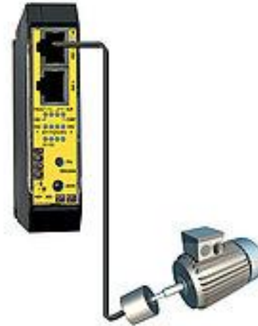
סיגנל ממד סיבובי מנוע מחובר ישירות לניטור מהירות
