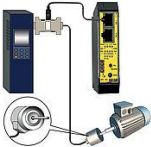
סיגנל ממד סיבובי מנוע מחובר להשוואה מול ממיר התדר
