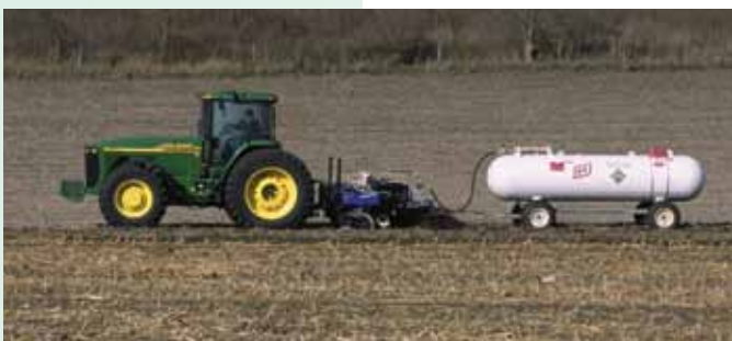
טרקטור גורר מערכת דישון המופעלת על ידי חיישנים
