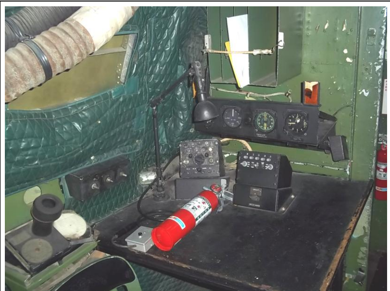
עמדת הנווט במטוס דקוטה (חסרים שני פנלי הפעלת ADF על הדופן משמאל)
